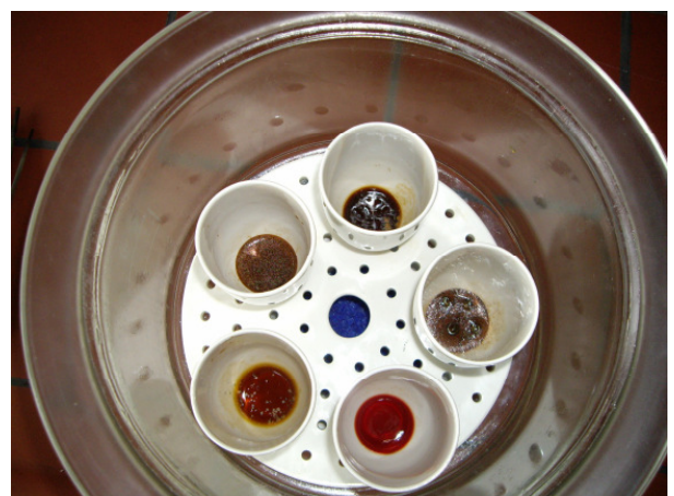
Abb. 2: Porzellantiegel mit Trockensubstanz im Exsikkator
